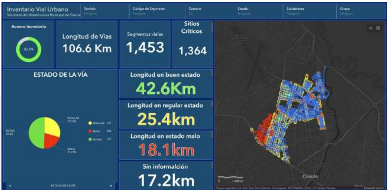
Ilustración 22 Estado de malla vial comuna 5
