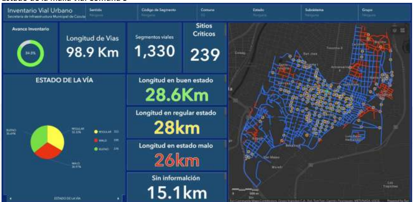
Ilustración 20. Estado de malla vial comuna 3
